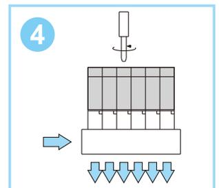
替換新電磁閥，自鎖型氣塊會自動將閥的進排氣孔打開
